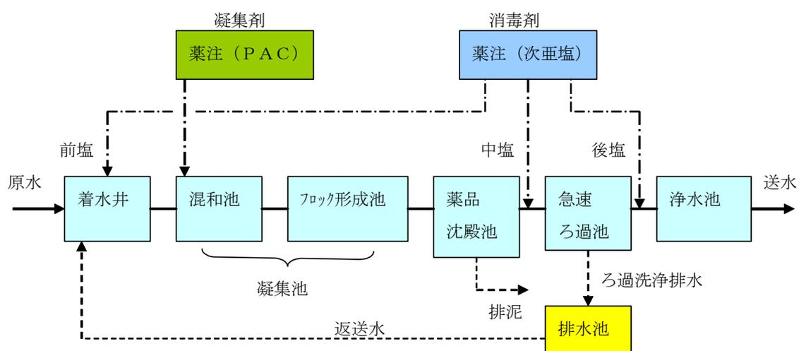
【静岡県相賀浄水場 浄水処理フロー】
